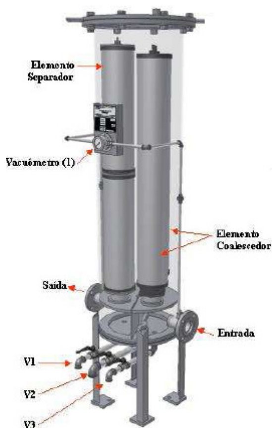
Instalação na sucção
