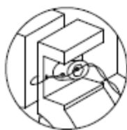
DETALHE DO PARAFUSO DE SELAGEM PARA SELAGEM DO SUPORTE DO MÓDULO CRA
